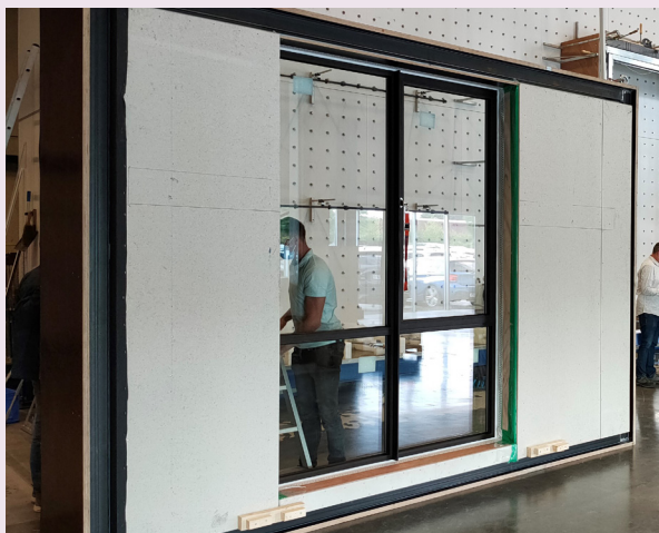
Gevelelement dat beproefd wordt op weersomstandigheden
